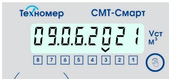
Рисунок 6 – индикация раздела «Дата прибора»
