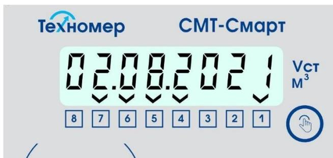
Рисунок 45 – Индикация раздела «Дата текущей поверки»
