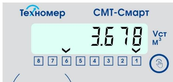
Рисунок 13 – индикация целой части раздела «Стандартный общий объем газа» в технологическом меню объема
