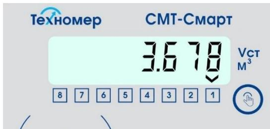
Рисунок 4 – индикация раздела «Стандартный общий объем газа» в основном меню
