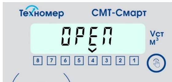
Рисунок 9 – индикация раздела «Состояние отсечного клапана»
