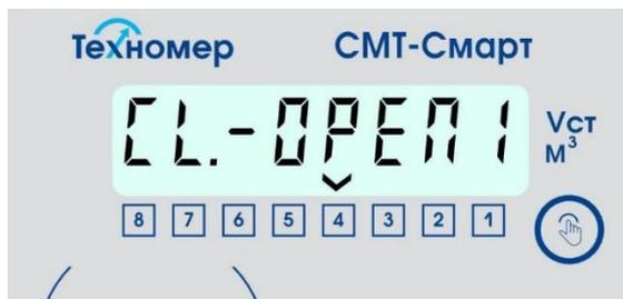
Рисунок 8 – индикация раздела «Состояние отсечного клапана»
