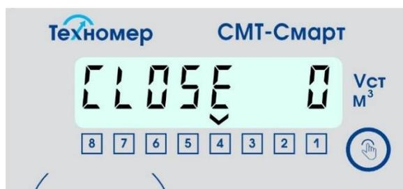
Рисунок 7 – индикация раздела «Состояние отсечного клапана»
