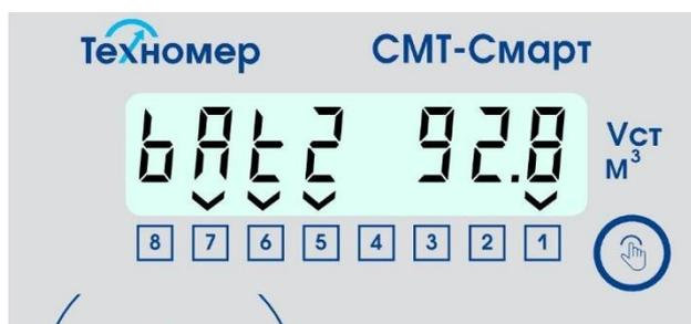
Рисунок 40 – Индикация раздела «Состояние основной батареи счетчика»
