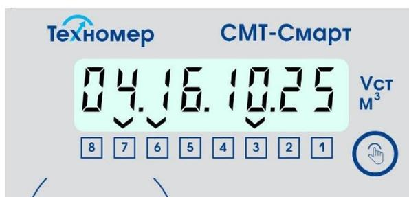
Рисунок 35 – индикация раздела «Режим передачи данных»
