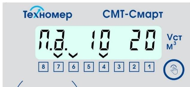
Рисунок 36 – индикация раздела «Передача данных»
