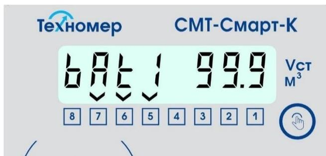
Рисунок 39 – Индикация раздела «Состояние резервной батареи счетчика»
