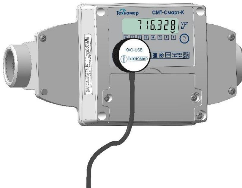
Рисунок 48 – считывание данных по оптическому интерфейсу при помощи КАО-USB
