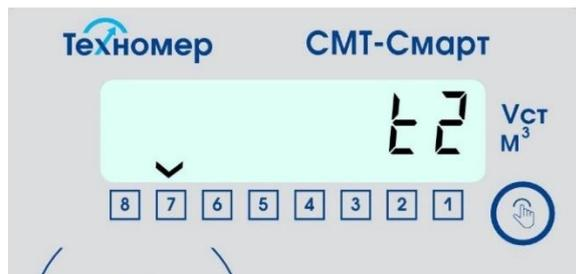
Рисунок 12 – индикация раздела перехода в «Технологическое меню»
