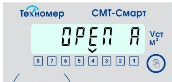
Рисунок 10 – индикация раздела «Состояние отсечного клапана»
