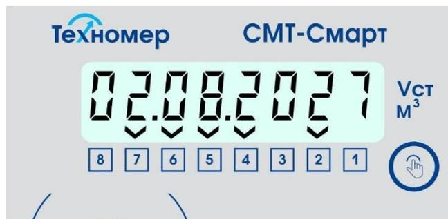
Рисунок 46 – Индикация раздела «Дата следующей поверки»
