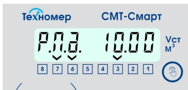
Рисунок 33 – индикация раздела «Режим передачи данных»
