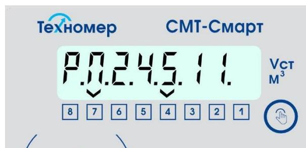
Рисунок 26 – индикация раздела «Регистр предупреждений» (зарегистрированы предупреждения П2, П4, П5, П11)
