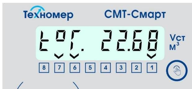
Рисунок 31 – индикация раздела «Температура газа» (температура газа 22,68°C)
