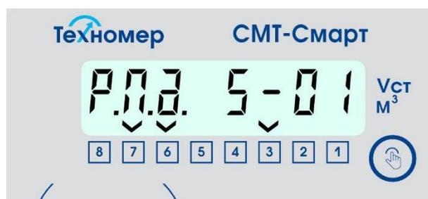
Рисунок 32 – индикация раздела «Режим передачи данных»
